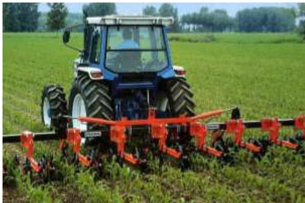
Passage de la bineuse dans une parcelle de maïs Source : Arvalis, Institut du végétal
