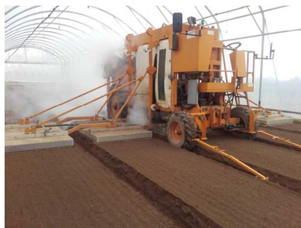
Nettoyage des planches de mâche à la vapeur (Photo CA BZH)
