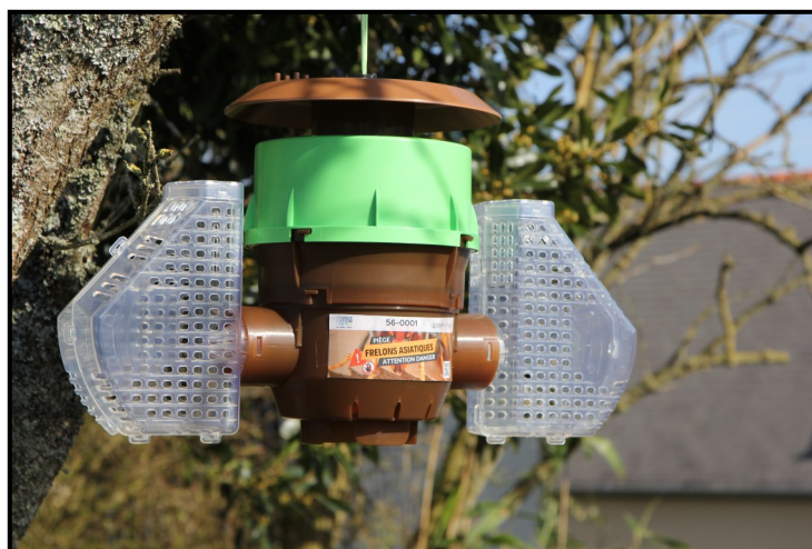
Piège sélectif utilisé pour la capture du frelon asiatique (Photo: FREDON Bretagne)
