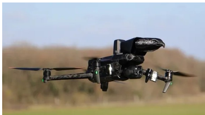
Drone effaroucheur Photo AG-robotique
