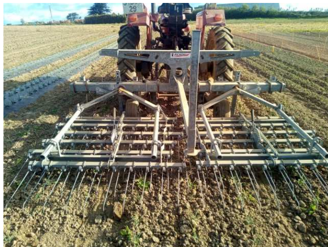
Passage de herse étrille pour nettoyer les parcelles en interculture (Photo CA BZH)
